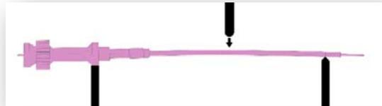
Après mesure, la technique consiste à effectuer une pression sur la partie convexe de la pièce sans la déformer plastiquement dans l'autre sens (figure suivante) par une force exercée manuellement mais limitée par une réduction de couple et une distance.
