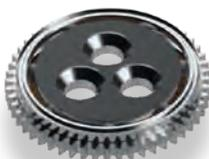
La masse oscillante est fixée sur la bague extérieure du roulement à billes, la partie centrale du roulement est fixée sur le mouvement. Lors du mouvement du poignet la masse oscillante tourne et entraîne les mobiles d'inversion. Le roulement à billes est utilisé pour éviter les pertes dues au frottement.
