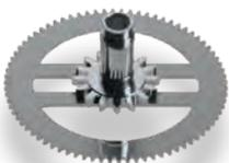
Le mobile de chaussée fait partie du mécanisme de mise à l'heure. Le mécanisme de mise à l'heure à deux fonctions soit de mettre la montre à l'heure par une action sur la tige de remontoir ou par l'entraînement du mobile de moyenne situé dans le train du rouage en fonctionnement normal. Le mobile de chaussée porte l'aiguille des minutes.
