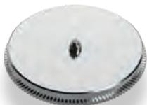
Le barillet se compose d'un disque cylindrique denté fermé par un couvercle. Il contient le ressort moteur, qui est accroché au barillet à l'extérieur et fixé sur l'axe du barillet. Comme l'axe est fixe le couple moteur est transmis par la rotation du barillet.
