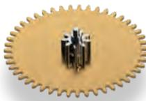
Le mobile de réduction réduit la vitesse de rotation du mécanisme de remontage sur le rochet. Cela augmente la force qui agit. Ainsi, une force suffisante est générée pour remonter le ressort.
