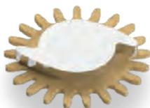
Le correcteur de quantièrre fait partie du mécanisme de calendrier. Le correcteur de quantièrre a pour fonction de faire sauter rapidement le disque de quantièrre sur le jour voulu lors de la mise à l'heure du mouvement.
