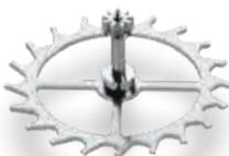
Le mobile d'échappement transmet l'énergie du barillet sur l'organe réglant par l'intermédiaire de l'ancre assemblée. Le rouage qui transmet l'énergie du barillet à l'organe réglant est composé du mobile de grande moyenne, du mobile de moyenne, du mobile de seconde et du mobile d'échappement.
