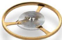
L'énergie transmise par le rouage sur le balancier avec son spiral permet à l'oscillateur d'osciller. Grâce à son isochronisme, le balancier réglé assure la régularité du déroulement du train d'engrenage et garantit ainsi la marche dans le mouvement mécanique.
