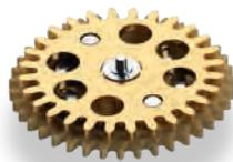
Comme le mobile d'inversion, le mobile d'inversion auxiliaire est utilisé par les montres mécaniques. La roue d'inversion auxiliaire change la direction de transmission du couple afin d'être dans le sens d'enroulement du ressort moteur.
