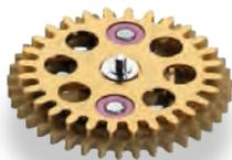
Le mobile d'inversion est un élément de rouage du mécanisme de remontage automatique dans le mouvement mécanique. En raison du mouvement du poignet, un couple agit sur le mobile via la masse oscillante. Grâce à ces cliquets, cette transmission se fait uniquement dans le sens d'enroulement du ressort moteur.
