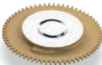
Le mobile entraîneur de l'indicateur de quantième fait partie du mécanisme de calendrier. Le mobile entraîneur de quantième a pour fonction de faire sauter une fois par jour le disque de quantième qui porte les 31 chiffres des jours du mois.
