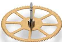
Le mobile de seconde est un élément du train du rouage; il transmet l'énergie reçue au mobile d'échappement qui assure le transfert d'énergie dans le mouvement mécanique entre le barillet et le balancier.
